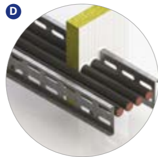
D Niet-brandbare doorvoeren zoals metalen buizen, kabelgoten en kabelladders
